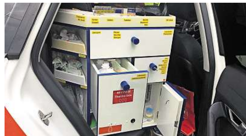
Zwei Fächer sind geöffnet: Das linke ist beheizt, um für den Notfall körperwarme Infusionen geben zu können. Das rechte Fach ist ein kleiner Kühlschrank – für Medikamente, die kalt aufbewahrt werden müssen.
